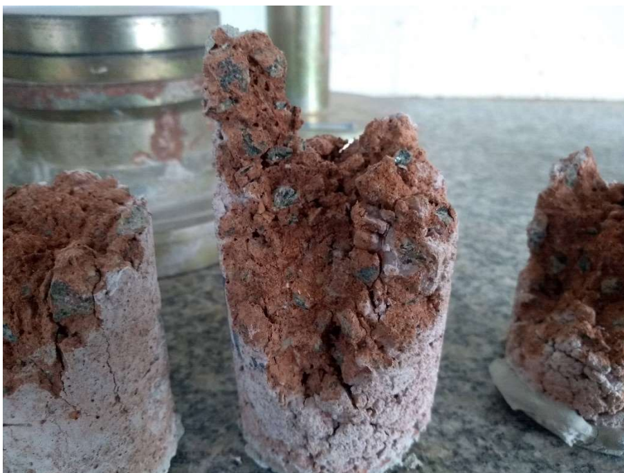
Figura 4.20: CPs de RB20 após ensaio de resistência à compressão. Fonte: (AUTORA, 2022).
