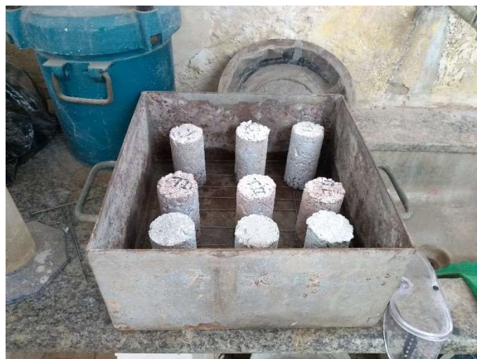
Figura 3.4: Ensaio de absorção de água por capilaridade.
