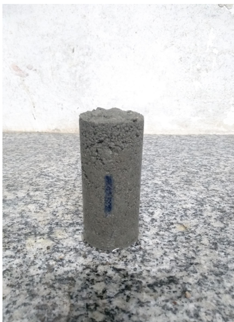
Figura 4.13: Corpo de prova do concreto seco após desmolde.
